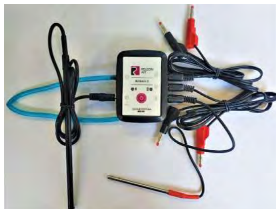
Рис. 9. Беспроводной мультидатчик Releon Air «Физика-5»
